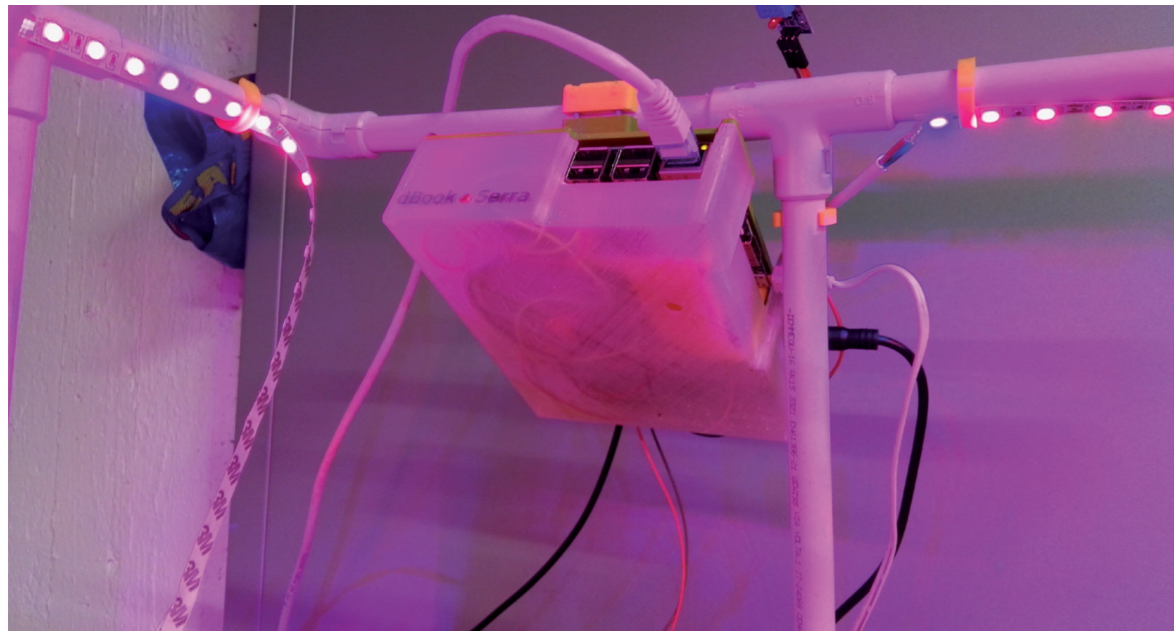
Fig. 9 - La prima versione del case del dSerra agganciata alla struttura di sostegno dei LED.
