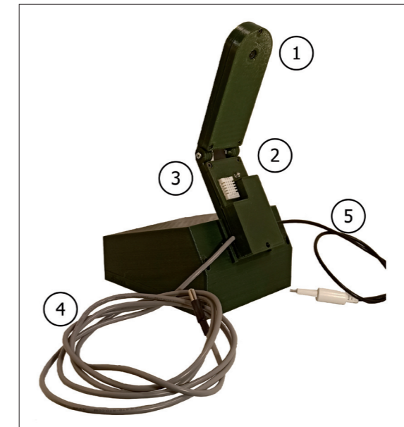
Fig. 10 - La versione attuale del case del dSerra. I numeri indicano rispettivamente: 1) webcam; 2) sensore di luminosità; 3) sensore di temperatura e umidità; 4) sonda per la temperatura dell'acqua di coltura; 5) sonda per la misura del TDS.
