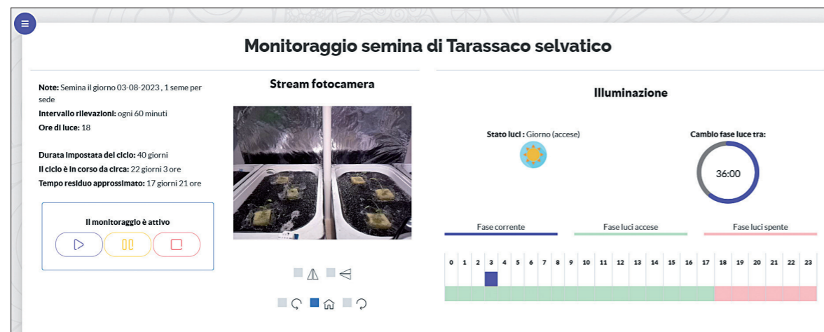
Fig. 7 - Particolare della pagina di gestione di un ciclo di crescita, comprendente le impostazioni di monitoraggio, i comandi per avviare e fermare l'acquisizione dati, lo stream della fotocamera e lo stato dell'illuminazione LED.
