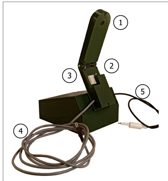
Fig. 10 - La versione attuale del case del dSerra. I numeri indicano rispettivamente: 1) webcam; 2) sensore di luminosità; 3) sensore di temperatura e umidità; 4) sonda per la temperatura dell'acqua di coltura; 5) sonda per la misura del TDS.
