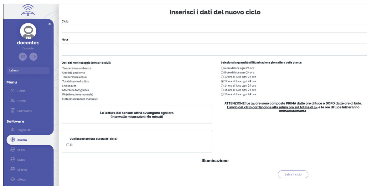
Fig. 6 - Procedura per la creazione di un nuovo ciclo di misura. Oltre al titolo e alle note, all'utente è chiesto di scegliere la lunghezza del fotoperiodo e una eventuale durata del ciclo complessiva.
